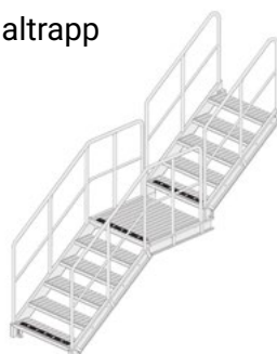
Toløpstrapp med hvilerepos
