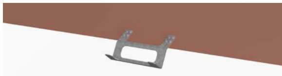
Sklisikring der takrenne mangler.
