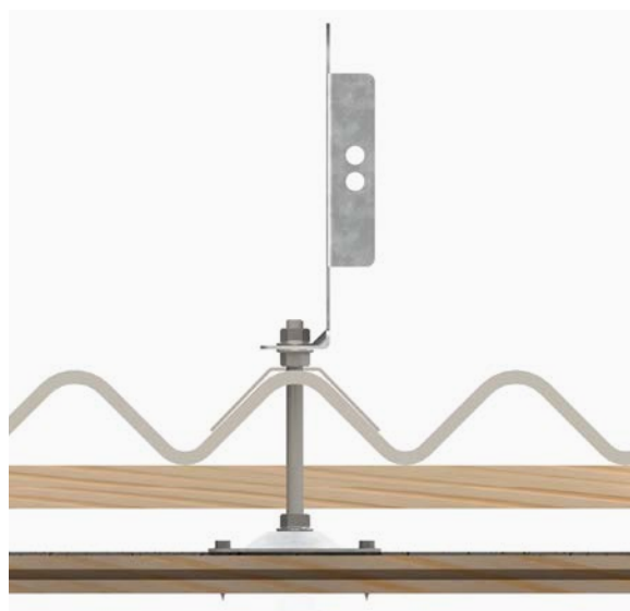
Innfesting i fibersementtak.
