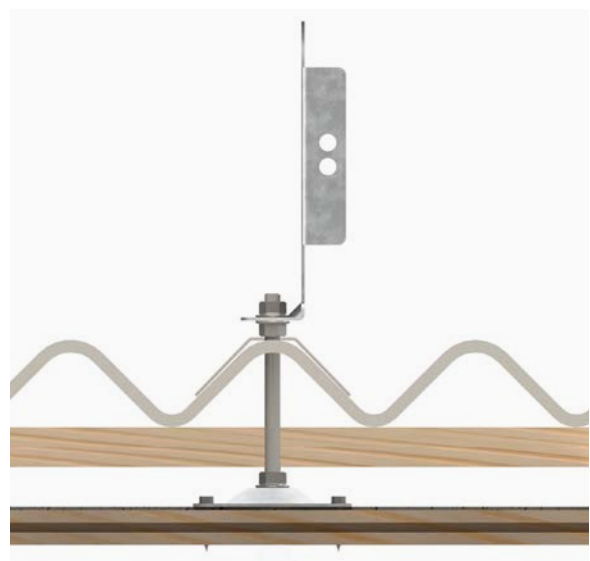
Innfesting i fibersementtak.
